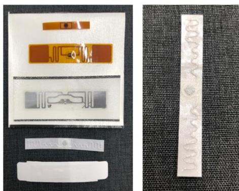
**Figura 2** diverse tipologie di RFID (sinistra), RFID utilizzato (destra).
