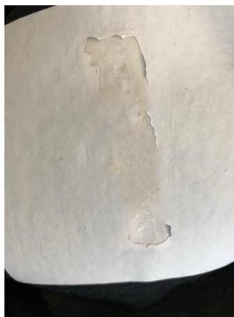
**Figura 3** Etichetta di 0,1cm, composta da RFID e lana di vetro termopressati sulla pezza durante la fase di rilevazione al metal detector della calandra (sinistra); etichetta graffiata dopo il processo di calandratura (destra)
